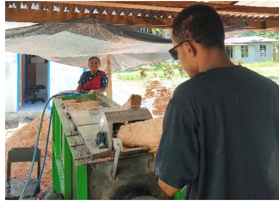
Gambar 2. Proses Pamarutan Empulur Batang Sagu dan Proses Ekstraksi Menggunakan Mesin Ekstraksi Pati Sagu Model Pengaduk Berulir yang Dilengkapi Unit Pamarut
